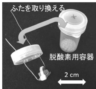
図 8 脱酸素剤による酸素濃度の制御
