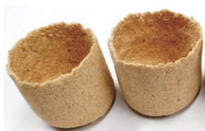
図6 完成した木粉ポット（側面）
